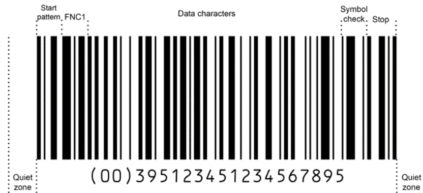
Abbildung 5.4.2-1. Allgemeines Format eines GS1-128 Strichcodes
