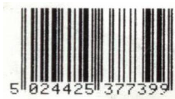
Abbildung 5.12.5.12-1. Symbol mit Problemen bei der Kantenvermessung
