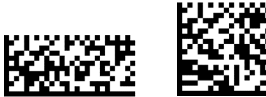
Abbildung 5.6.3.1-1. Rechteckiges und quadratisches GS1 Data Matrix Symbol (Es wird keine spezielle Anwendung in der Codierung repräsentiert. Beide Symbole enthalten dieselben Daten)
