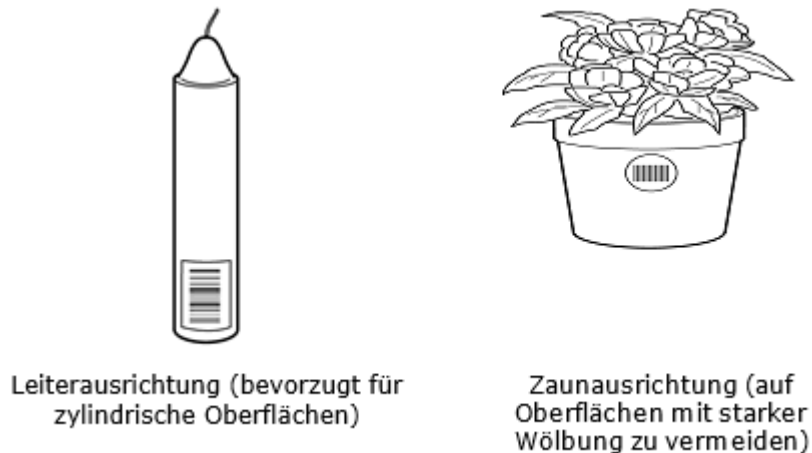
Abbildung 6.2.3.2-1. Barcodeplatzierung auf gewölbten Oberflächen
