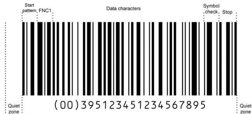
Abbildung 5.4.2-1. Allgemeines Format eines GS1-128 Strichcodes
