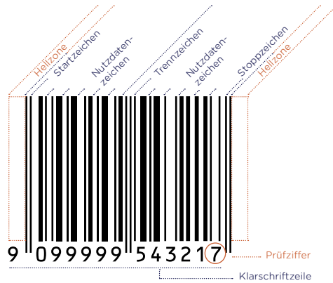
Aufbau eines EAN-13
